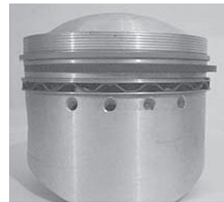
படம் 5.3.7.3(ஆ) குவிவு தலை வடிவ பள்ளம்
