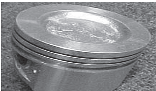
படம் 5.3.7.3(இ) குழிவு தலை வடிவ பள்ளம்
